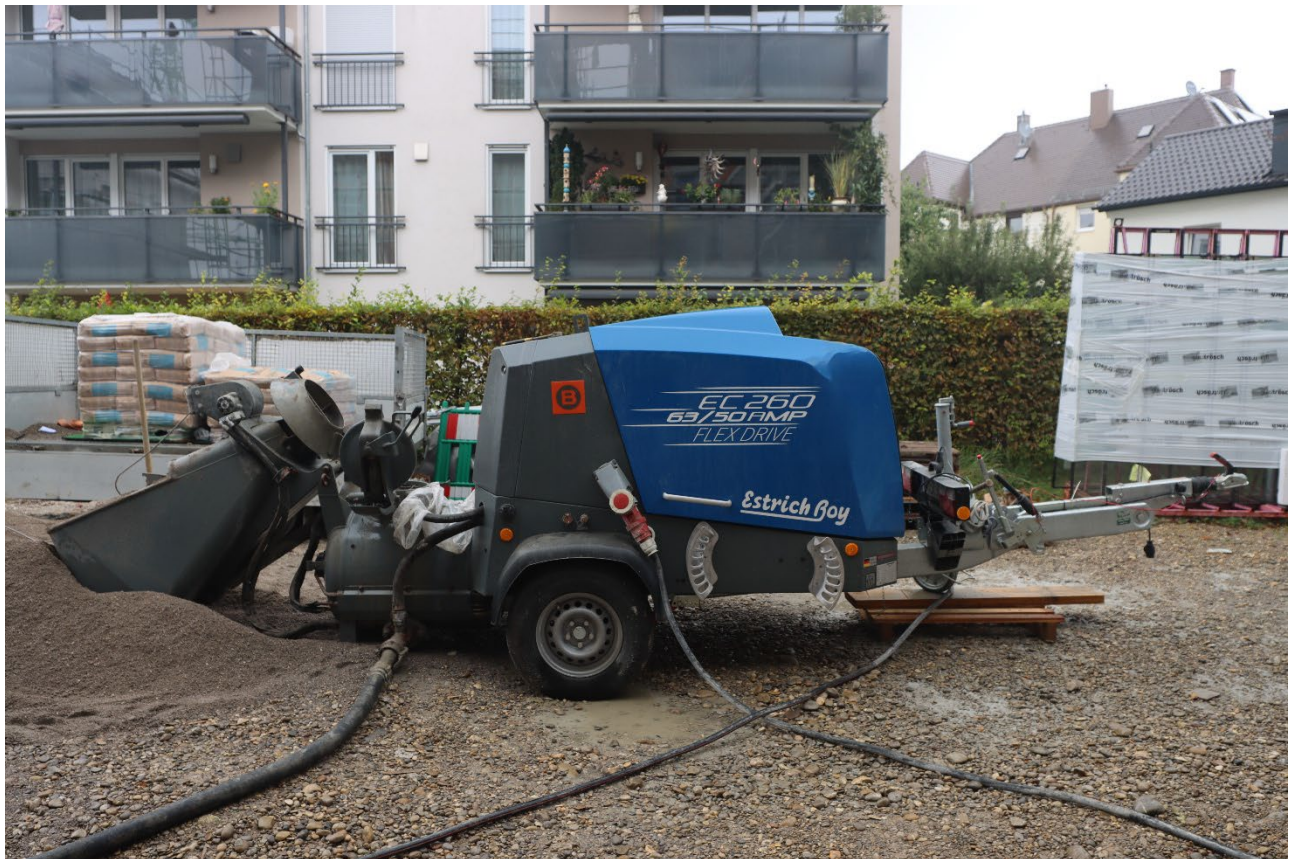
Die neue EtrichBoy EC 260/45 der H.E.I.M. Estrich GmbH im Einsatz
